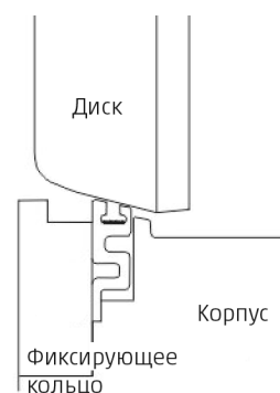
Уплотнение затвора после воздействия огня (пожара)
