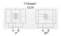
При подаче сжатого воздуха в порт А поршни раздвигаются, вал вращается против часовой стрелки.
