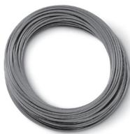
Трубопровод HTR-NAB (HYTREL) из полиэстера морозостойкого исполнения предназначен для применения в составе пневматических тормозных систем транспортных средств. Соответствует требованиям ISO 7628:2010 и ГОСТ Р 52452-2005. Обладает высоким значением давления на разрыв при высоких значениях рабочей температуры.
