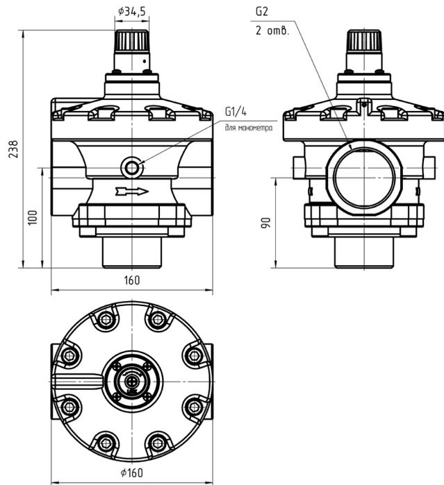
PR02 = регулятор со сбросом давления
