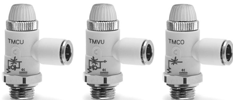
Пневмодроссели с обратным клапаном и без него Серии TMCU, TMVU, TMCO обладают малыми размерами и улучшенными расходными характеристиками. Конструкция дросселей обеспечивает простую установку непосредственно на цилиндры и распределители, а также позволяет заблокировать настроечный винт после установки расхода (скорости передвижения).
